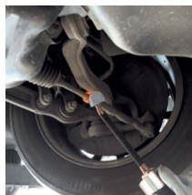
Déblocage des biellettes de direction
