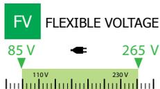
A mala possui tecnologia de Tensão Flexível (FV) e permite uma tensão de alimentação de 85 a 265 V.
