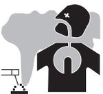
切割产生的烟雾，气体和灰尘对人体有害。预先准备好足够风力的风扇，保持空气流通。若通风不足，可使用新鲜空气面罩。
