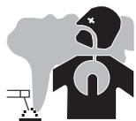
Fumi, gas e polveri emessi dalla saldatura sono pericolosi per la salute. È necessario prevedere una ventilazione sufficiente: potrebbe rendersi necessario un apporto d'aria. Una maschera ad aria fresca potrebbe essere una soluzione in caso di aerazione insufficiente.
