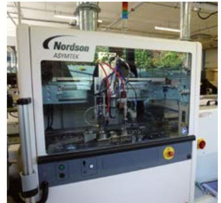
La planta de producción de tarjetas electrónicas se ha equipado con una nueva máquina para barnizado, que permite limitar los depósitos de polvo y la corrosión. Todas las tarjetas de GYS se barnizarán, lo cual es un criterio importante para las zonas donde existe fuertes niveles de humedad.
