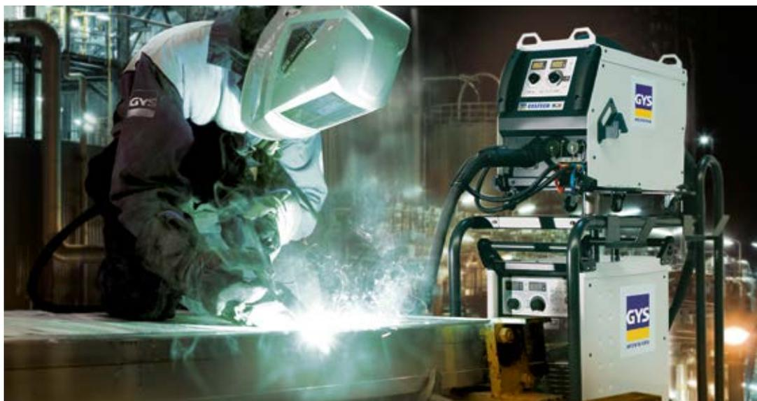
*El generador Exagon 400 multiproceso (MMA / MIG-MAG / TIG) ha sido diseñado sobre una electrónica de tecnología punta y de una estructura reforzada. Ofrece una productividad óptima y conviene a numerosas aplicaciones en la industria u obras navales como las instalaciones off-shore. Como todos los productos, posee un código QR que permite al cliente acceder a la ficha técnica del producto mediante un smartphone.*
