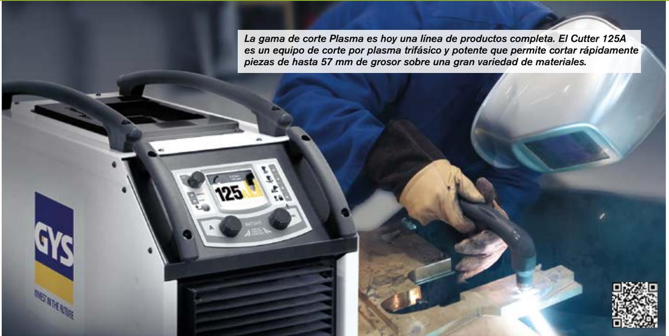
La gama de corte Plasma es hoy una línea de productos completa. El Cutter 125A es un equipo de corte por plasma trifásico y potente que permite cortar rápidamente piezas de hasta 57 mm de grosor sobre una gran variedad de materiales.
