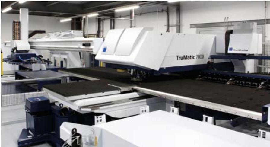
Entre las inversiones recientes se encuentra esta máquina de doble cabezal en su taller de chapistería, que es capaz de realizar al mismo tiempo operaciones de perforación y de corte láser. Permite trabajar con piezas de mayor grosor, con el valor añadido de ahorro de tiempo y mayor calidad de corte.
