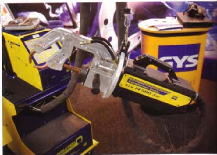
Der C-Arm C10 ist zum Schweißen von Blech-Außenflanschen konzipiert.
