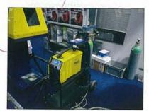
Gys sort un nouveau poste Mig Inverter pour un usage occasionnel. Conservant les fonctionnalités des modèles dimensionnés pour des travaux quotidiens, le Pearl se distingue par sa bobine de fil de 100 à 200 mm (1 à 5 kg) et son fonctionnement avec ou sans gaz. La commande est automatiquement adaptée à l'épaisseur de la tôle avec la fonction "Synergic". Fonctionnant sur 220 V avec seulement 13 ampères, le Pearl est compact et léger.
