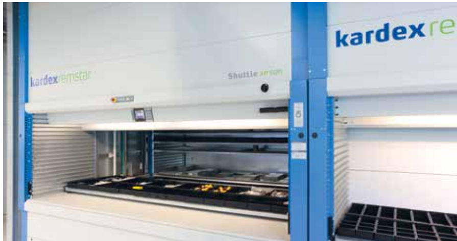
Über 11 Millionen Elektronik-Bauteile werden in einem Kardex Shuttle-Lagersystem über zwei Ebenen aufbewahrt.
