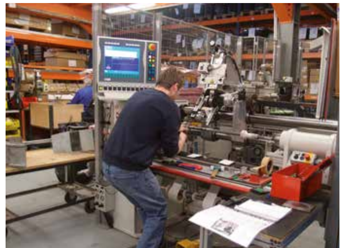
Hochgeschwindigkeit herrscht in der eigenen Drahtwicklei. 15.000 Trafos können täglich mit der Sondervorrichtung produziert werden.
