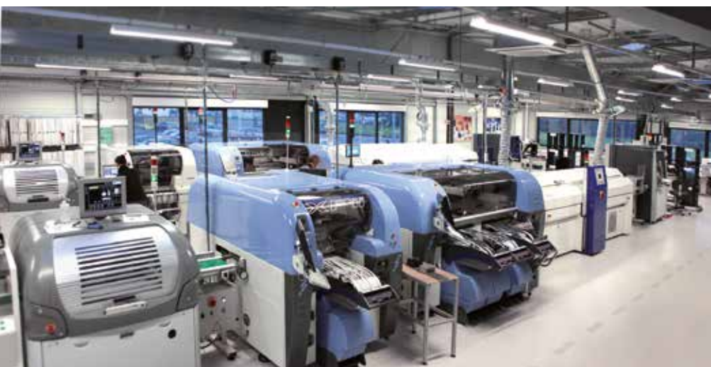
Die Bestückung der Halbleiterkarten erfolgt vollautomatisch.
