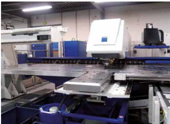
Blechtafeln werden automatisch zugeführt und der Werkzeugwechsel geschieht in dem Blechbearbeitungszentrum blitzschnell und fast ebenso mannos, wenn die künftigen Gehäuseteile genibbelt, gestanzt und geformt werden.
