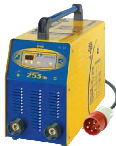
Lancé cette année, le Gysmi 253 Cel est un poste de soudage à l'électrode triphasé industriel de 250 A. Sa dynamique d'arc exceptionnel lui permet de souder tous types d'électrodes, dont les électrodes celluloseuses. Sa conception intègre un couloir de ventilation protégeant le système électronique des poussières métalliques.
