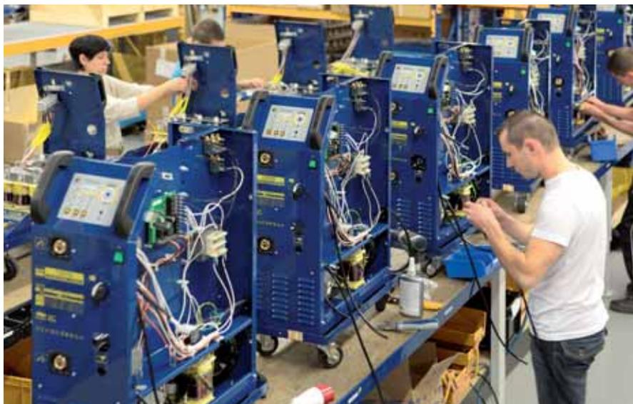
Les produits semi-œuvrés fabriqués dans les différents ateliers de l'usine française de Gys sont assemblés sur 24 lignes de montage. Les produits finis subiront un dernier test puis seront identifiés par un numéro en garantissant la traçabilité avant de rejoindre le stock central du fabricant de 2 800 m<sup>2</sup>.
