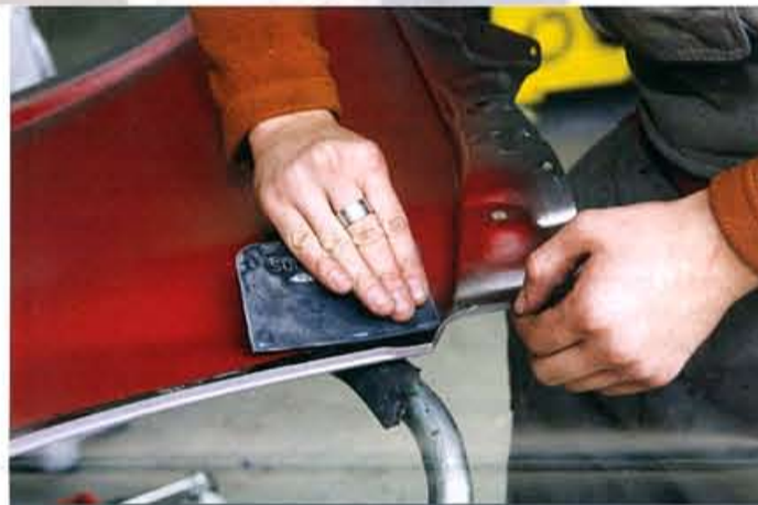
Vor dem Schweißen wird Klebstoff auf das neue Karosserieteil aufgebracht. Danach muss innerhalb von 30 Minuten geschweißt werden...
