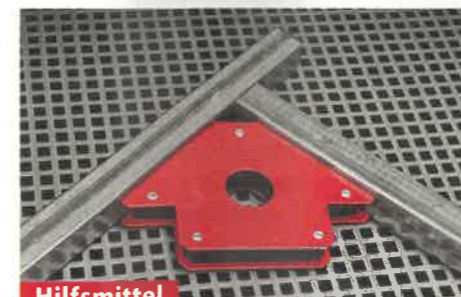
Hilfsmittel Mit einem Winkelmagnet stellen Sie ohne Gefummel exakte Verbindungen her. Alle Anlageflächen sind magnetisch.
