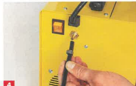
4 Der gleiche Vorgang erfolgt auf der Seite des Schweißgeräts. Später den Gasdruckminderer am besten montiert belassen.
