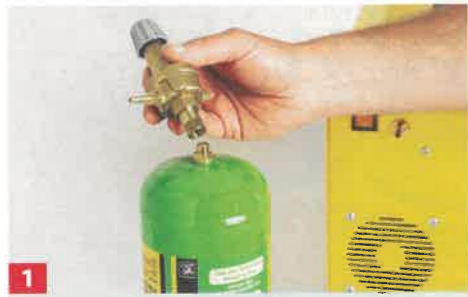
1 Auf die hier verwendete Einmal-Gasflasche mit Ventilanschluss wird zunächst ein geeigneter Druckregler aufgeschraubt.
