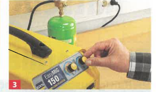
3 Die Stärke des Schweißstroms und der Voranschub des Schweißdrahts werden am Gerät vorgewählt. An Teststück ausprobieren!
