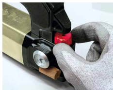
Presión ajustable de 0 > 6.5 bar
