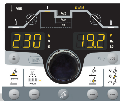
Bediening met dubbele display, met draaiknop en drukknop voor een snelle instelling
