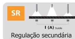
**Regulação secundária** - Independentemente da tensão de entrada e as variações em distância entre o eléctrodo e o metal, a maquina assegura um arco estável para uma ótima qualidade.
