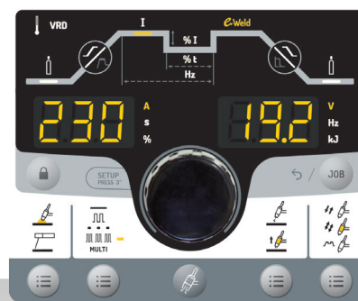
Пользовательский интерфейс с двумя дисплеями и поворотной кнопкой для быстрой настройки параметров
