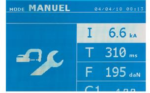
يتيح لك المفتاح تحديد وظيفة تعديل المشبك. تتيح لك وظيفة "ضبط المشبك" إغلاق المشبك وتطبيق قوة التثبيت المبرمجة على الأقطاب الكهربائية دون مرور تيار. يظل المشبك مغلقاً طالما أن المشغل يضغط على الزناد. تتيح لك هذه الوظيفة التحقق من توسيط البتات.
