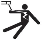
لا تلمس أبدًا الأجزاء الحية داخل أو خارج مصدر التيار المنخفض (المشاعل ، المشابك ، الكابلات ، الأقطاب الكهربائية) لأنها متصلة بدائرة اللحام.
