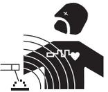
ينتج التيار الكهربائي الذي يمر عبر أي موصل مجالات كهربائية ومغناطيسية موضعية (EMF). ينتج تيار اللحام مجالاً كهرومغناطيسياً حول دائرة اللحام ومعدات اللحام.
