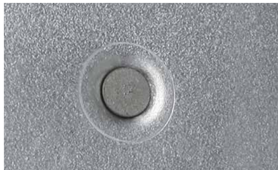
VÝSLEDEK OSAZENÍ ZALISOVACÍHO NÝTU
