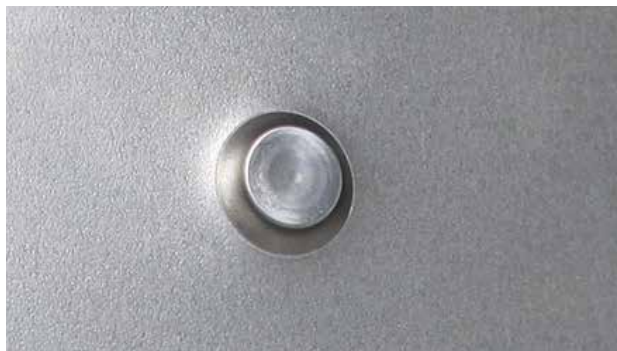
VÝSLEDEK OSAZENÍ ZALISOVACÍHO NÝTU
