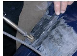
Arbeitsstelle durch Blasen von Kunststoff-, Metallpartikeln und Staub reinigen und mit Seifenwasser reinigen und entfetten (Schwamm ausspülen).
