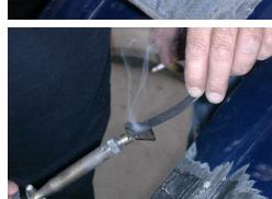
Cette opération étant terminée, laissez refroidir (vous pouvez refroidir à l'air avec une soufflette). En face avant, poncez largement autour de la cassure. Chanfreiner les bords de la cassure. Vous pouvez chanfreiner en utilisant l'extrémité de la panne, côté pointu, en fondant le plastique.
