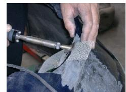
Ne pas appuyer sur le fer. La T° de 550°C de la panne est suffisante pour faire remonter la matière en fusion dans les trous du grillage. Cette opération effectuée, d'ores et déjà et pour un coût dérisoire votre pare-chocs a déjà une excellente résistance à l'arrachement et aux chocs (Photo 2).
