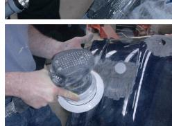
Soufflez, nettoyez, dégraisssez (de l'eau savonneuse suffit) rincez, dépoussiérez. Remplissez le chanfrein avec notre baguette d'apport ref. 052956. Préchauffez la baguette (photo 3), jusqu'à ce qu'elle soit en fusion sur la moitié de l'épaisseur (ce geste est important, il permet à l'apport de bien se marier par capillarité avec le support).
