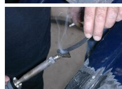
Fixieren Sie nun das Gitter final unter Verwendung eines JBDC Kunststoff-Lötstabes (Art.-Nr. 052956):
