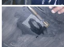
Pour supprimer les défauts d'aspects ou manque de matière, un mastic spécial plastique peut être utilisé.
